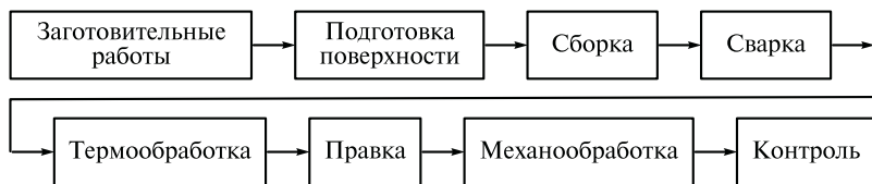
Рис. 22.1. Схема технологического процесса изготовления сварных конструкций
