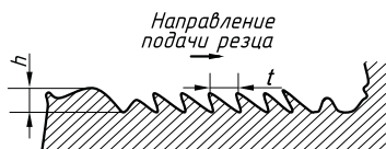
Рис. 9.7. Профиль поверхности вала, подготовленной к напылению (глубина h = 0,7 \dots 0,8 мм; шаг t = 1,6 \dots 2,0 мм)
