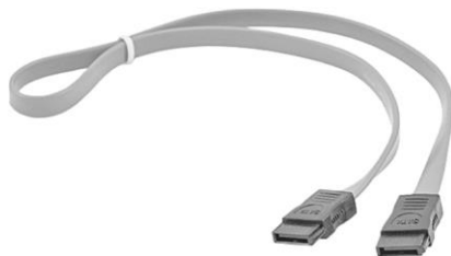
3.1 -сурет. SATA деректерінің шлейфі мен кабелі
