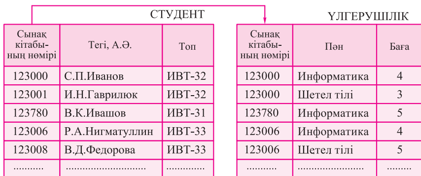
13.1-сурет. Реляциялық деректер қорының сызбасы
