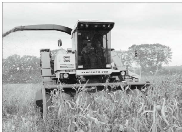
4.5-сур. Өздігінен жүретін жүгері өңдейтін КСКУ-6 («Херсон-ец-200») комбайны
