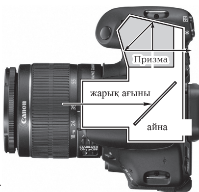
6.6 сурет. Айналық фотокамераның сұлбасы
