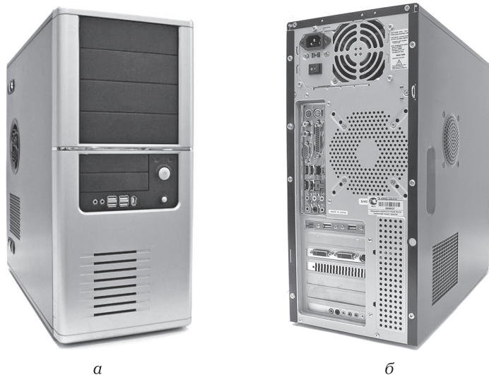
1.16.сурет Дербес компьютердің желілік блогы: а – алдыңғы түрі; б — артқы түрі
