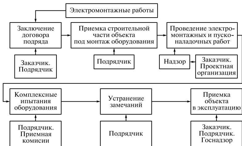
Рис. 1.2. Основные этапы проведения электромонтажных работ
