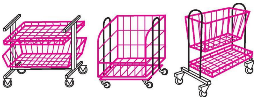
5.8-сурет. Пішім будаларын, бөлшектерді және жартылай фабрикаттарды ауыстыруға және сақтауға арналған еден үстінде тасымалданатын контейнерлі қоларбалар
